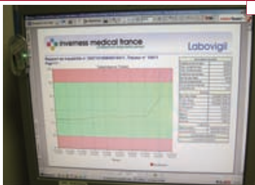
۱۳-۱۷ وصل کردن دیتالاگر به رایانه و مشاهده منحنی دمای حمل و نقل
