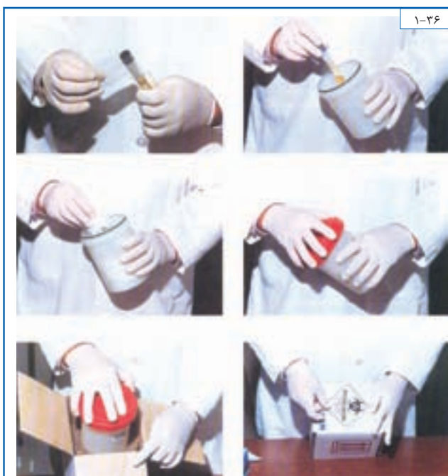
نحوه بسته بندی با پوشش ۳ لایه برای حمل و نقل مواد عفونی ۱۲
