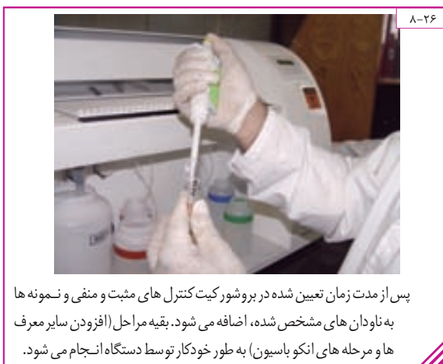
استریپ هادر ناودان (Trough) قرار داده شده و سپس بافر به استریپ ها اضافه می شود.
