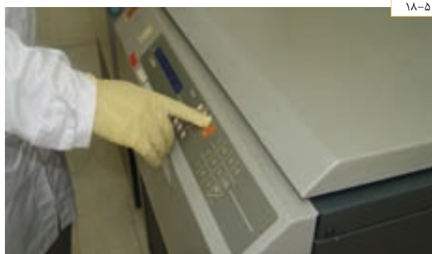
پس از بالانس نمودن در سانتریفوز قرار داده شده و با G مناسب سانتریفوز می‌شوند
