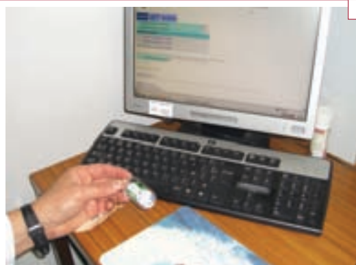
۱۳-۱۶ وصل کردن دیتالاگر به رایانه برای بررسی دمای حمل و نقل
